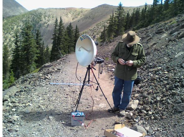
2<sup>nd</sup> rig Based on Kuhne Transverter, 2 Watts TX, LNF LNA
